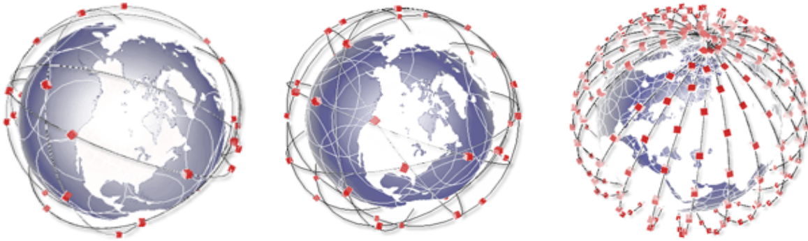
Obr. 8 Globalstar (veľké LEO) 48 satelitov Orbcomm (malé LEO) 35 satelitov Globalstar Teledesic (veľké LEO) 288 satelitov
