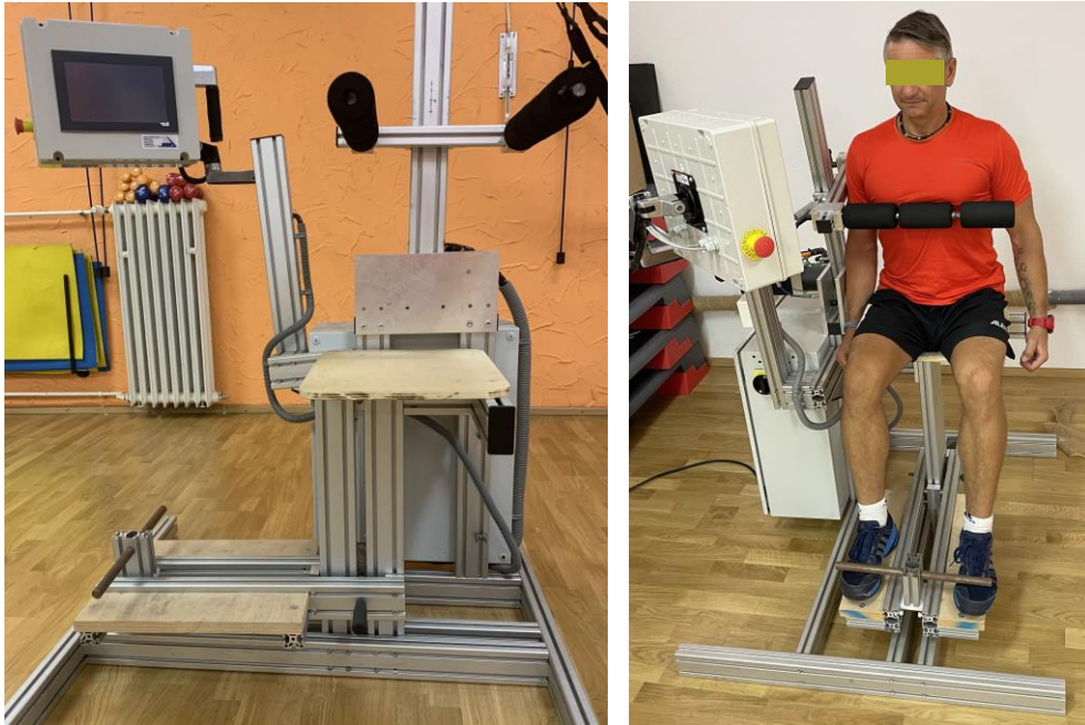
Prototyp tréningového a diagnostického systému na posilňovanie svalov v oblasti trupu a ich posudzovanie
